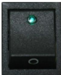
Abb. 16: Netzschalter
