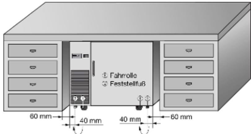
Abb. 10: Einbauansicht
