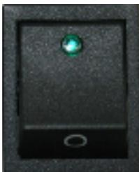
Abb. 54: Netzschalter
