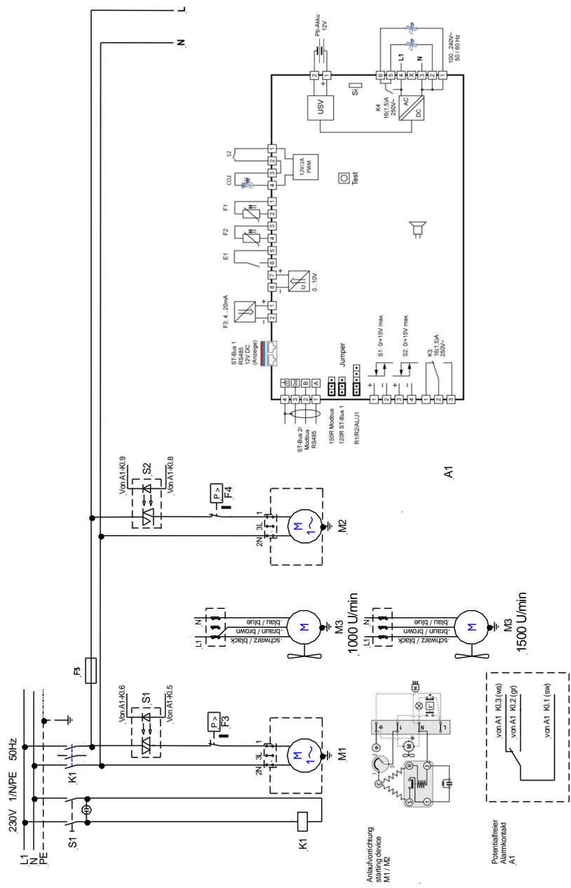
Abb. 145: Schaltplan\_Tiefkühlschrank\_VF15085\_230V\_50Hz
